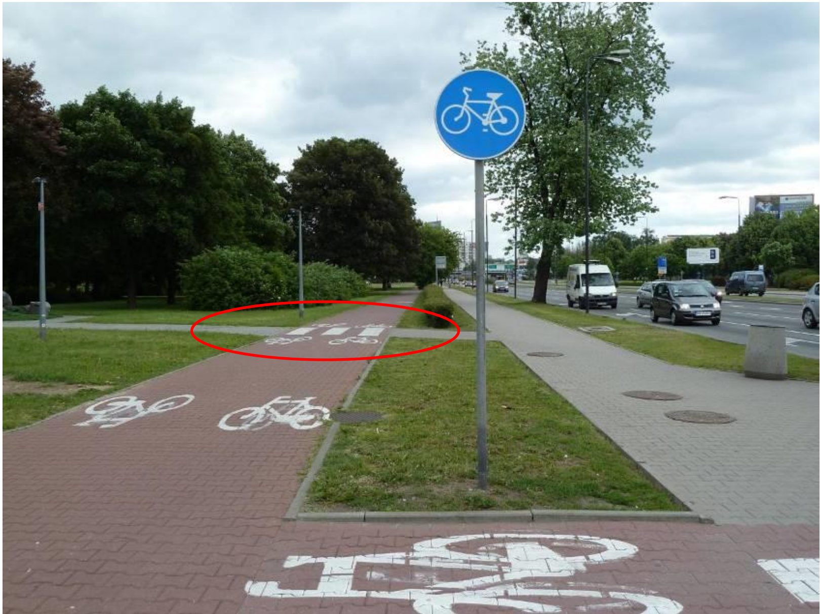
Skuteczna separacja ruchu pieszego i rowerowego oraz problematyczne oznakowanie przejścia dla pieszych.
